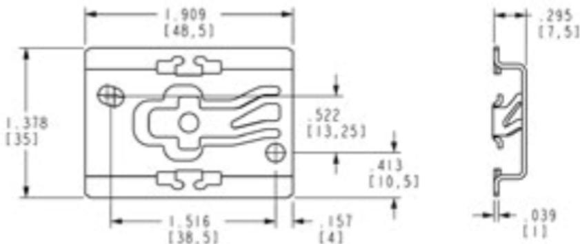
NOTA: El XMD es compatible con el riel DIN estándar de 35 mm. Use las dimensiones del soporte para obtener el tamaño adecuado del riel DIN.
