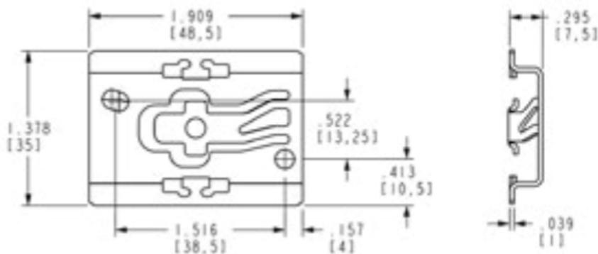
HINWEIS: Der XMD kann auf einer Standard 35mm DIN-Schiene montiert werden. Nutzen Sie die Halterungsabmessungen, um eine passende DIN-Schiene zu bestellen.
